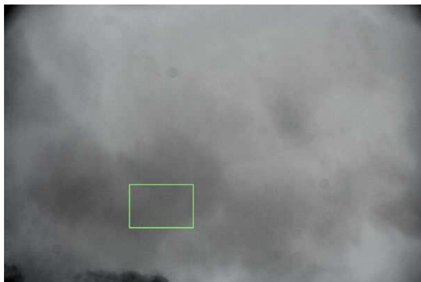
zdjęcie wykonane po odkurzeniu matrycy, kilka plam zniknęło, w tym największa, która była w miejscu zaznaczonym zieloną ramką, jednak większość brudu pozostała
